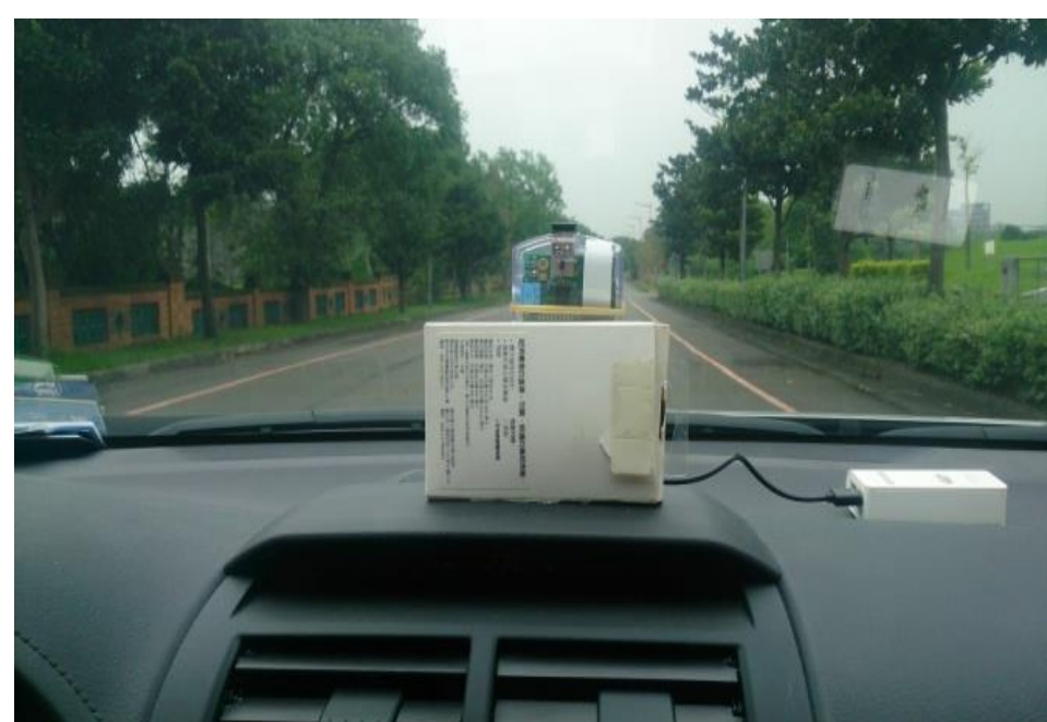
圖三. 鏡頭架設於儀錶板中心
